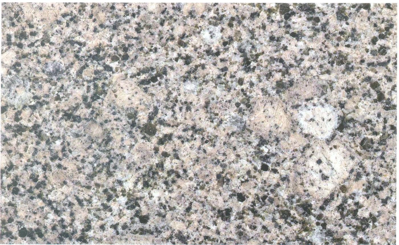
Рис. 7. Гранит рапакиви эксплуатируемого месторождения Возрождение (участок 8)
