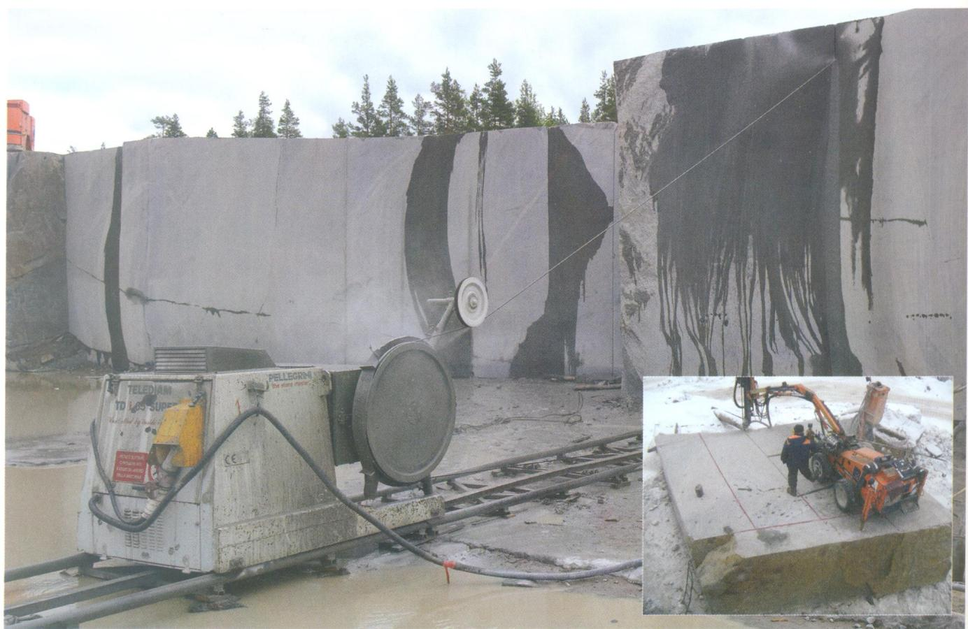
Фото 68–69. Месторождение Балтийское — промышленный карьер облицовочного камня: граносиенит добывают с применением технологии алмазо-канатного пиления
