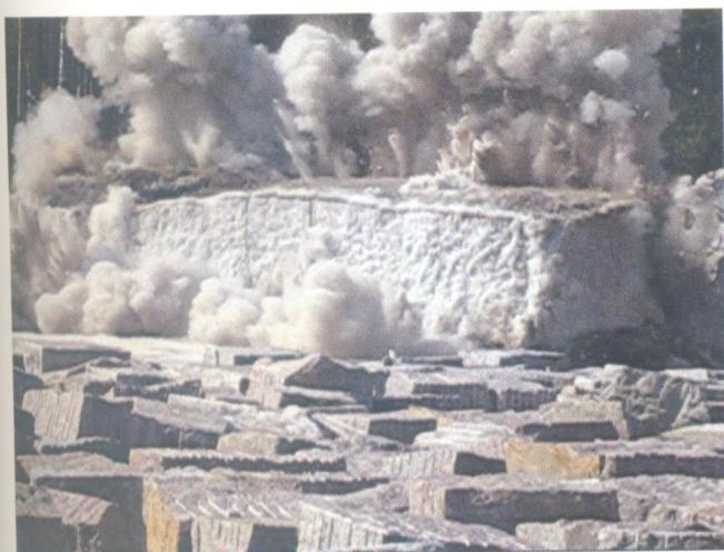
Фото 63. Отделение первичного монолита по буро-взрывной технологии на месторождении Ладожское, 2007 год
