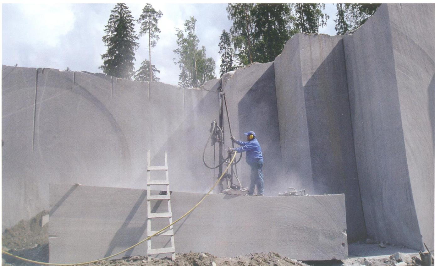
Фото 67. Месторождение Елизовское — промышленный карьер облицовочного камня: граносиенит добывают с применением технологии алмазо-канатного пиления
