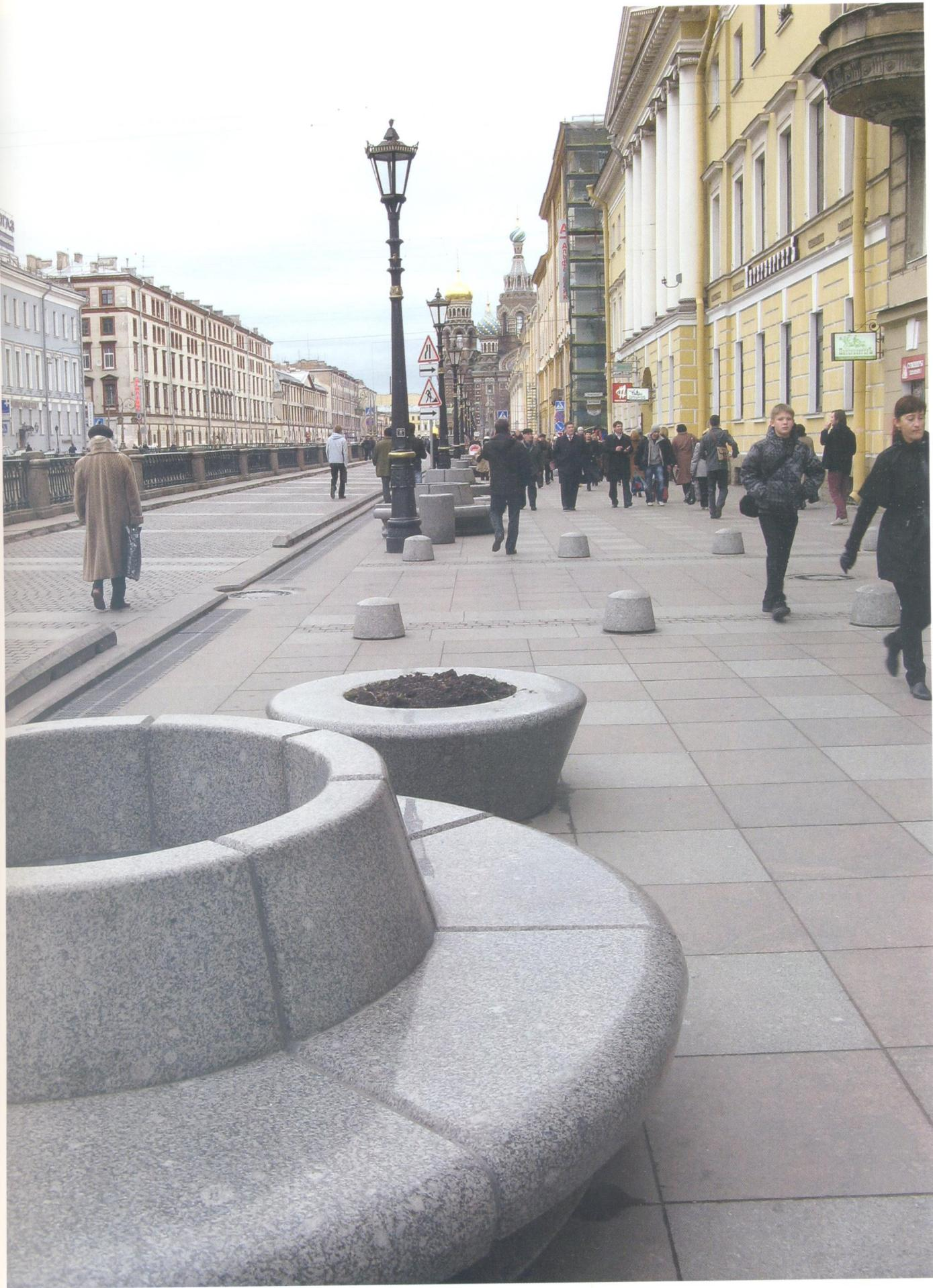
Фото 59. Реконструкция набережной канала Грибоедова, 2011 год: граниты рапакиви месторождения Возрождение (участок 8), граносиениты месторождений Ояярвинской группы
